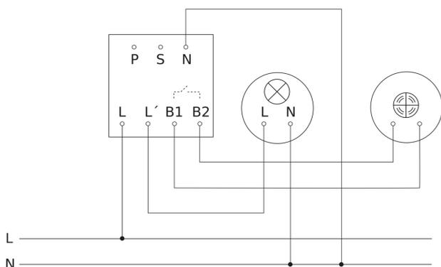
Schema elettrico Master-Slave collegamento in rete
